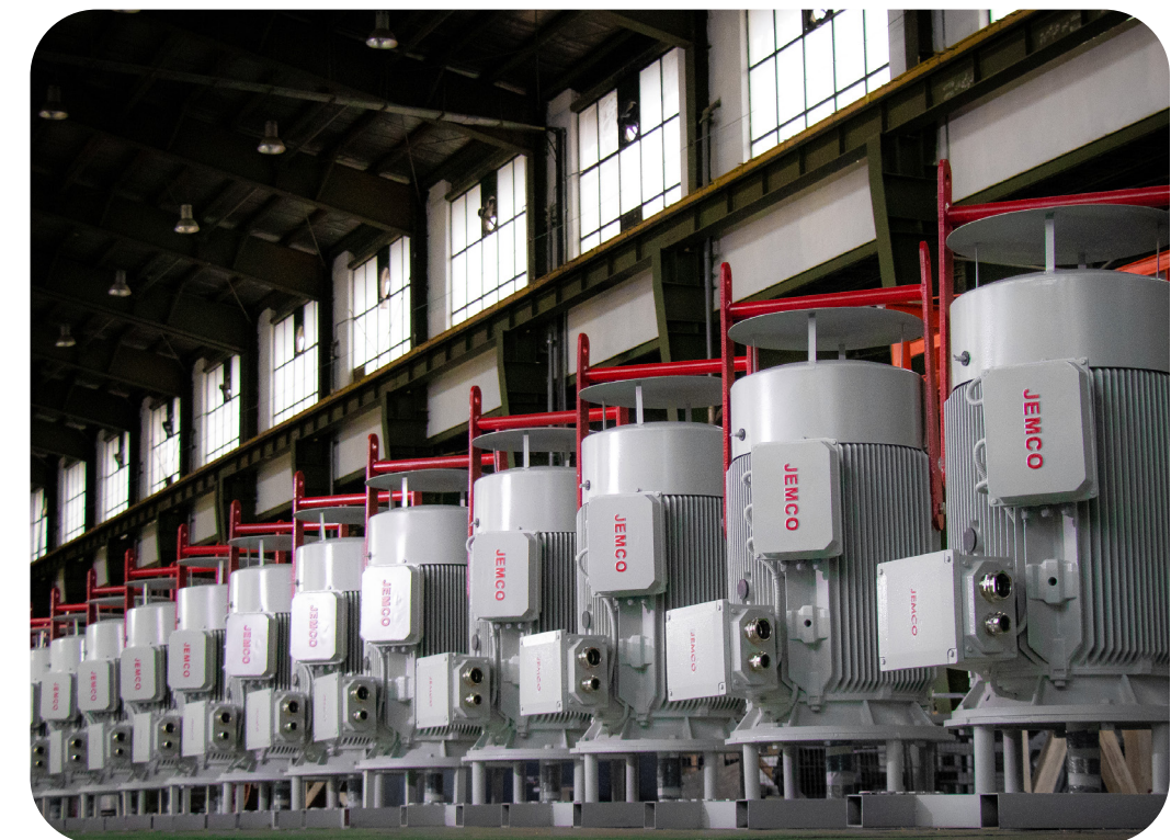
تولید الکتروموتورهای دو سرعته و دو توانه برای اولین بار در ایران برای نیروگاه رمیله عراق
